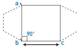
① a-bに対して90度になる方向を確認し、裾部cの位置を決めループにベグを打ち込みます。
