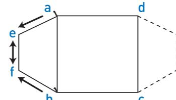
① e-f部のラダーロックコードの長さを調整し、a-e、b-f、e-fが直線となるようにベグで仮止めします。
