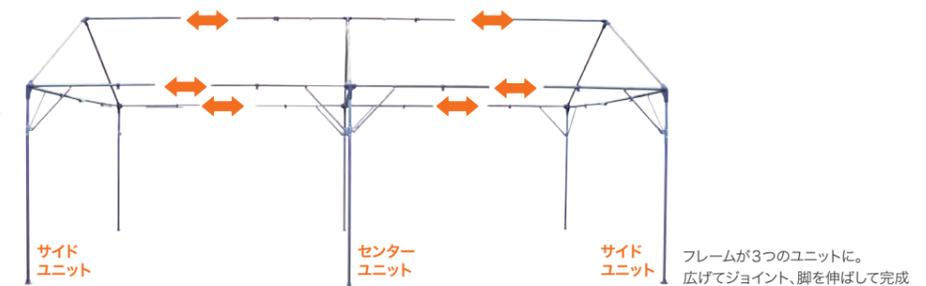
フレームが3つのユニットに。広げてジョイント、脚を伸ばして完成
